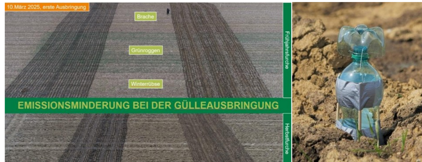
Darstellung: © Karl Mayer Versuchsaufbau Ammoniak-Ausgasung, geschlitzt (li), bodennah (re),
